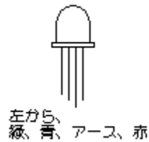
第1図 LEDのピン配置
